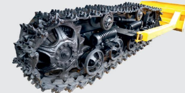
Торфяная модификация трактора АГРОМАШ 90ТГ предназначена для использования на сельскохозяйственных, мелиоративных, строительных и других операциях на почвах с повышенной и чрезмерной влажностью, заболоченных участках и слабонесущих почвах.
